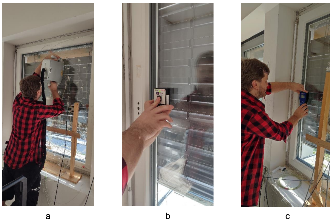
Obrázok 1 – Priebeh meraní; a - meranie koncentrácie plynu, b - zisťovacie prítomnosti nízkoemisnej vrstvy, c — meranie skladby zasklenia
