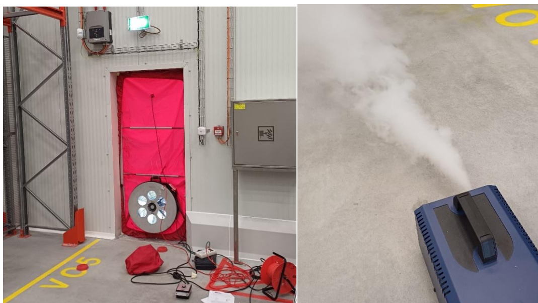
Obrázek 17 – Diagnostika těsnosti mrazíren a chladíren pomocí BDT a kouře
