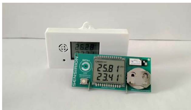
Obrázok 3 – Bezdrôtové snímače Sensirion SHT4x Smart Gadget (referenčný návrh bez ochranného krytu a finálna verzia s vyvinutým ochranným krytom)
