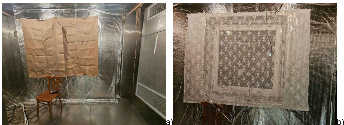
Obrázok 3 – Textilná bariéra A) Juta; B) záclona
