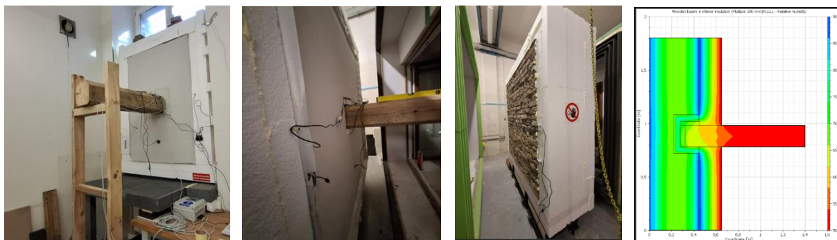
Obrázok 5 – Fotografie výskumného pracoviska VUT Brno s inštalovaným fragmentom a vlhkostné polia na modeli detailu
