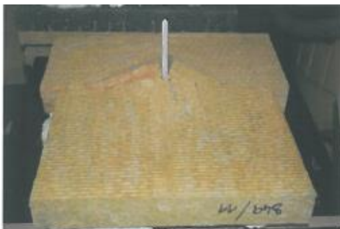
Obrázek 5 – Zkušební vzorky desek MW TR10, CS(10)30 po zkoušce
