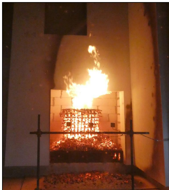
Obrázek 5 – Požární zatížení vzorku po 45 minutách zkoušky
