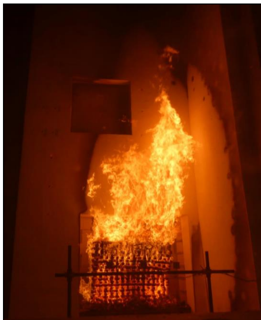
Obrázek 4 – Požární zatížení vzorku po 30 minutách zkoušky
