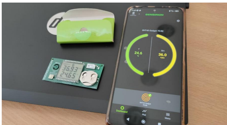
Obrázok 2 – Použité snímače napájané gombíkovými batériami a aplikácie v smartfóne na sťahovanie meraných údajov pomocou Bluetooth
