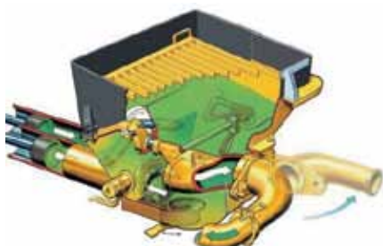
Obr. 6 Piestové čerpadlo čerstvého betónu [10]
