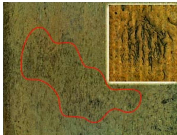
Obr. 10: Zle rozptýlená výstuž odhalená po odfrézovaní povrchu dosky (vpravo hore – detail chumáča ocelových vlákien)
