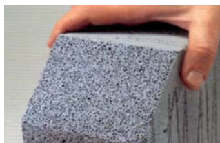
Obr. 1 Rez pórobetónovým prvkom odhaľujúci pórovú štruktúru [2]
