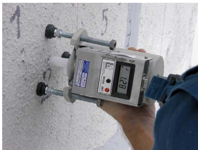
Obr. 5 Výťažná skúška rozpernej kotvy
