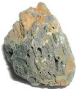
Obrázok 1: Pórová štruktúra LWA (USA)
