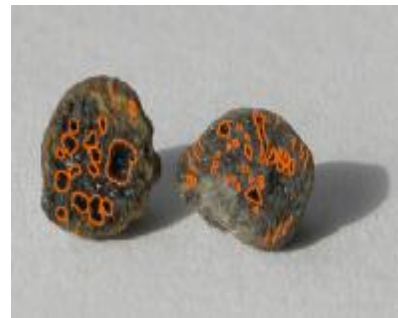
Obrázok 2: Pórová štruktúra LWA (EU)
