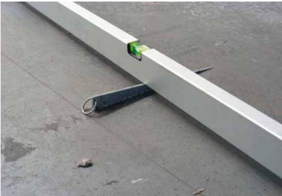
Obr. 3: Meranie miestnej rovinnosti klinom
