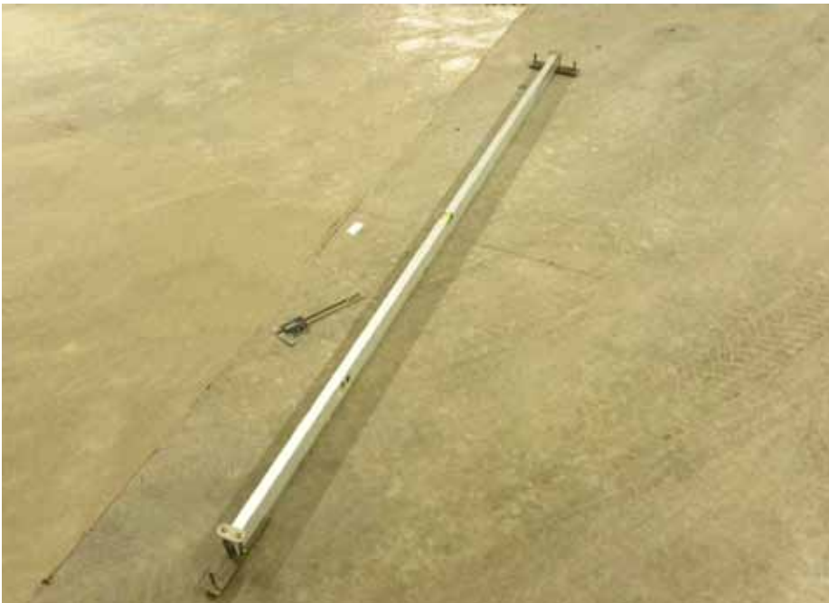
Obr. 4: Meranie miestnej rovinnosti posuvným meradlom
