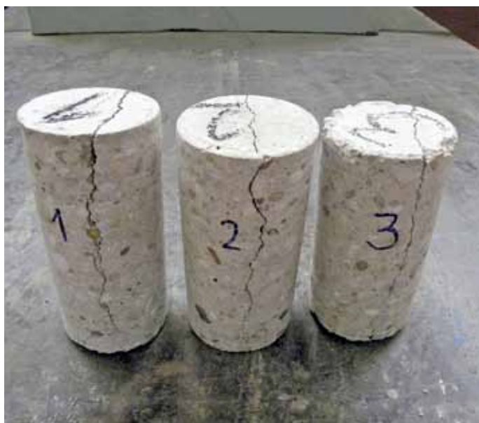
Obr. 6: Trhliny prechádzajúce celou hrúbkou stropnej dosky
